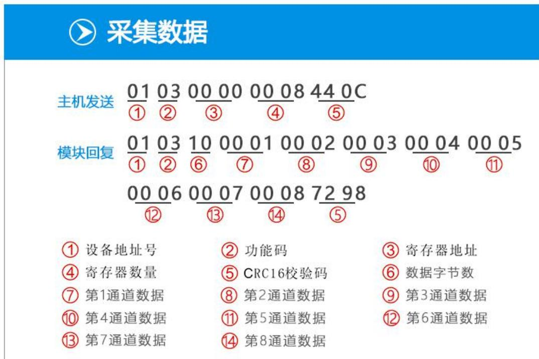
主机发送命令解析：设备默认地址号为 1 (0x01)，Modbus-RTU 功能码 3 (0x03) 为读取寄存器数据，DAM 模块数据起始寄存器地址为 0 (0x0000)，8 通道对应的需要读取的寄
